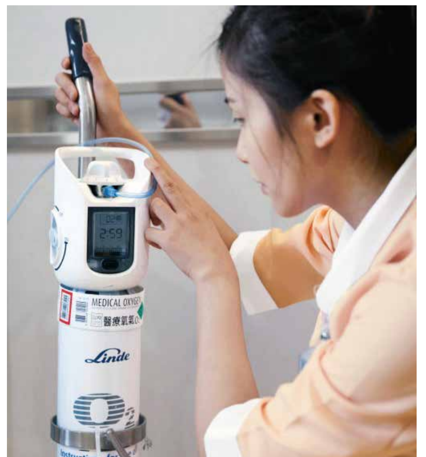
Lindes neueste Innovation ist LIV IQ - ein Ventil mit einer intelligenten Anzeige, welche den verbleibenden Gasinhalt in mobilen Gasflaschen anzeigt. © Linde AG
