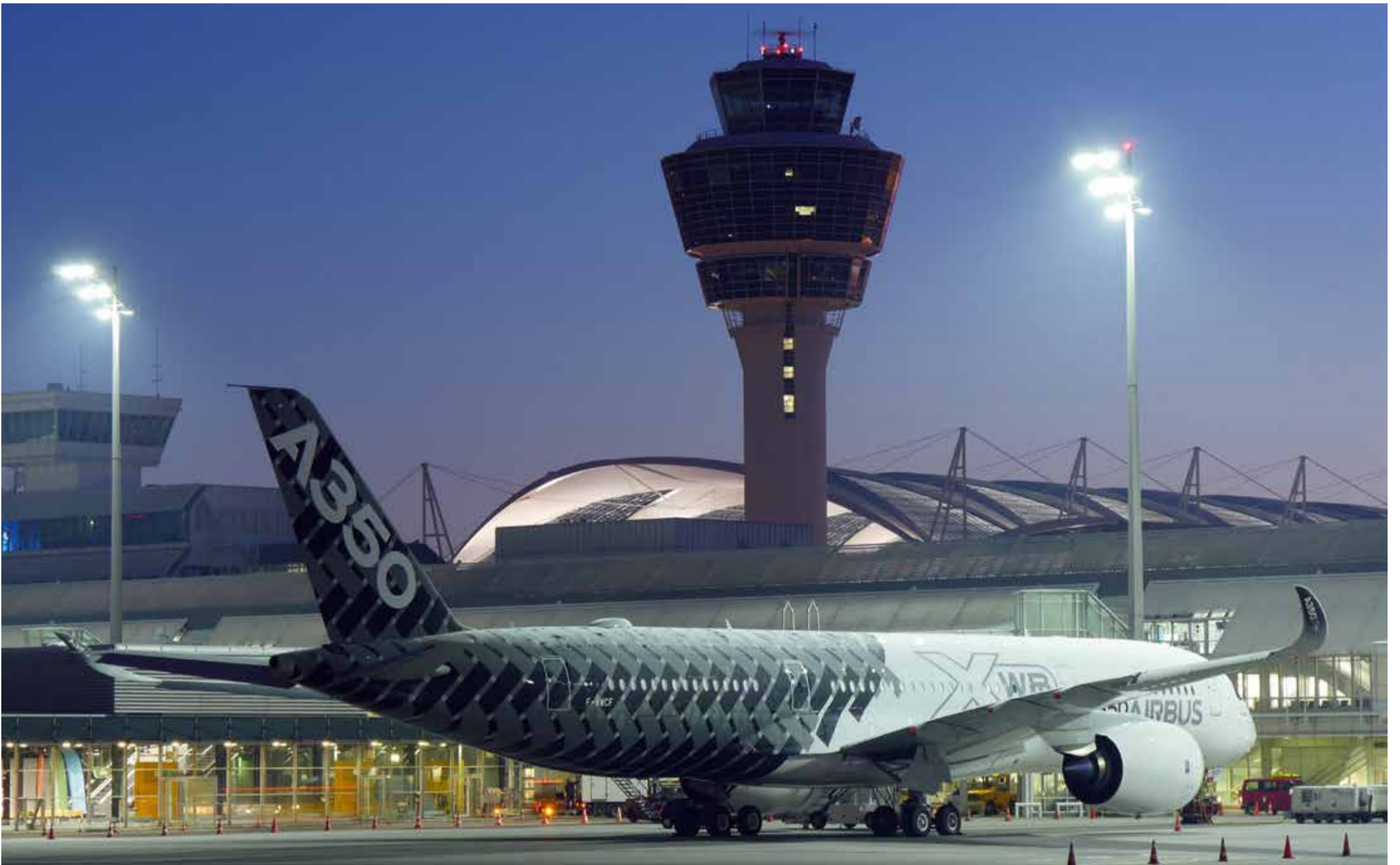
Das neue Super-Langstreckenflugzeug A350 XWB hat eine Reichweite von 14.500 Kilometern. Angetrieben wird das Flugzeug durch das neue Rolls-Royce-Triebwerk Trent XWB.
