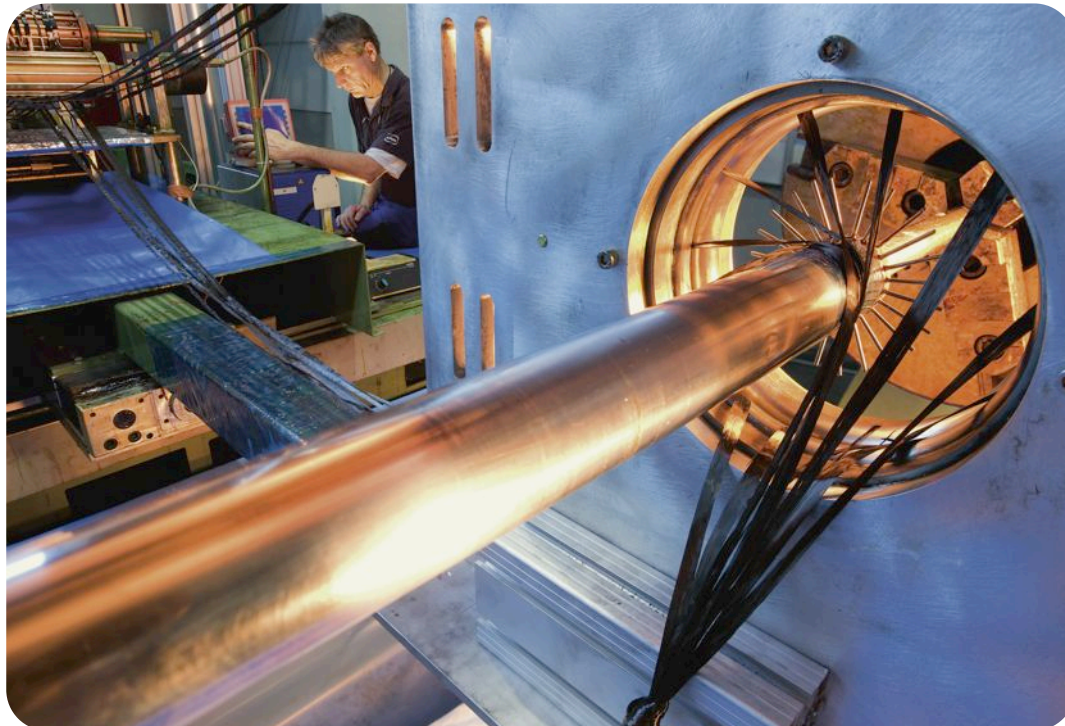
An einer Wickelmaschine stellt Schunk extrem hitzebeständige Komponenten aus Kohlefaserverbundwerkstoff her, die bei der Herstellung von hochreinem Silizium, dem Hauptbestandteil von Solarmodulen, zum Einsatz kommen. © Schunk Group
