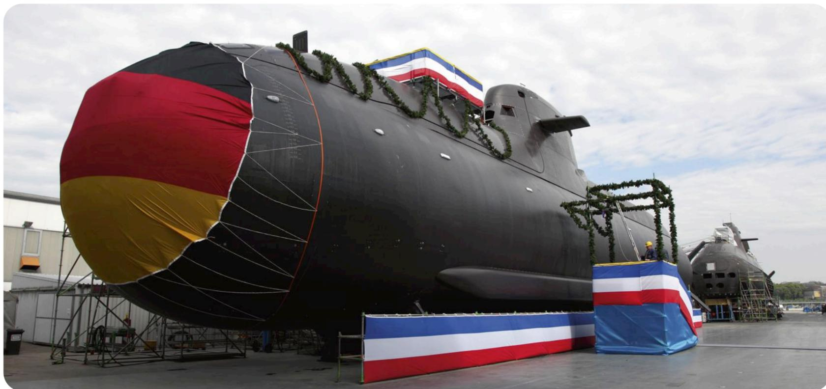
Kurz vor der Tauffeier von „U 36“ in Kiel: Das modernste konventionelle U-Boot vom Typ 212 A mit Brennstoffzellen-Antrieb auf dem Werftgelände von ThyssenKrupp Marine Systems. © ThyssenKrupp
