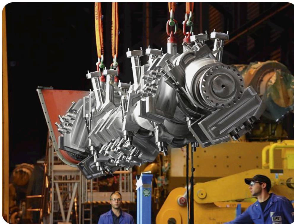
Das „Herz“ – die sechs Tonnen schwere Kurbelwelle – wird in den Gasmotor eingesetzt.
