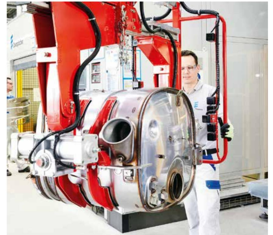
Modernste Technik für Nutzfahrzeug-Diesel: Euro-6-Abgasanlagen für Nutzfahrzeuge bei der Produktion.
