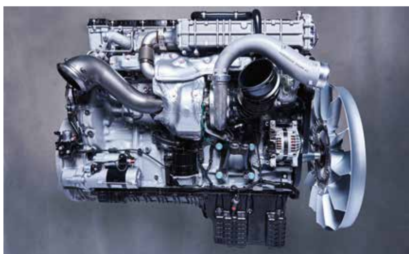
Spitzenprodukt von Mercedes Benz: Der innovative Dieselmotor OM 471 für Nutzfahrzeuge verbindet Ökonomie und Ökologie (Euro VI). © Mercedes-Benz
