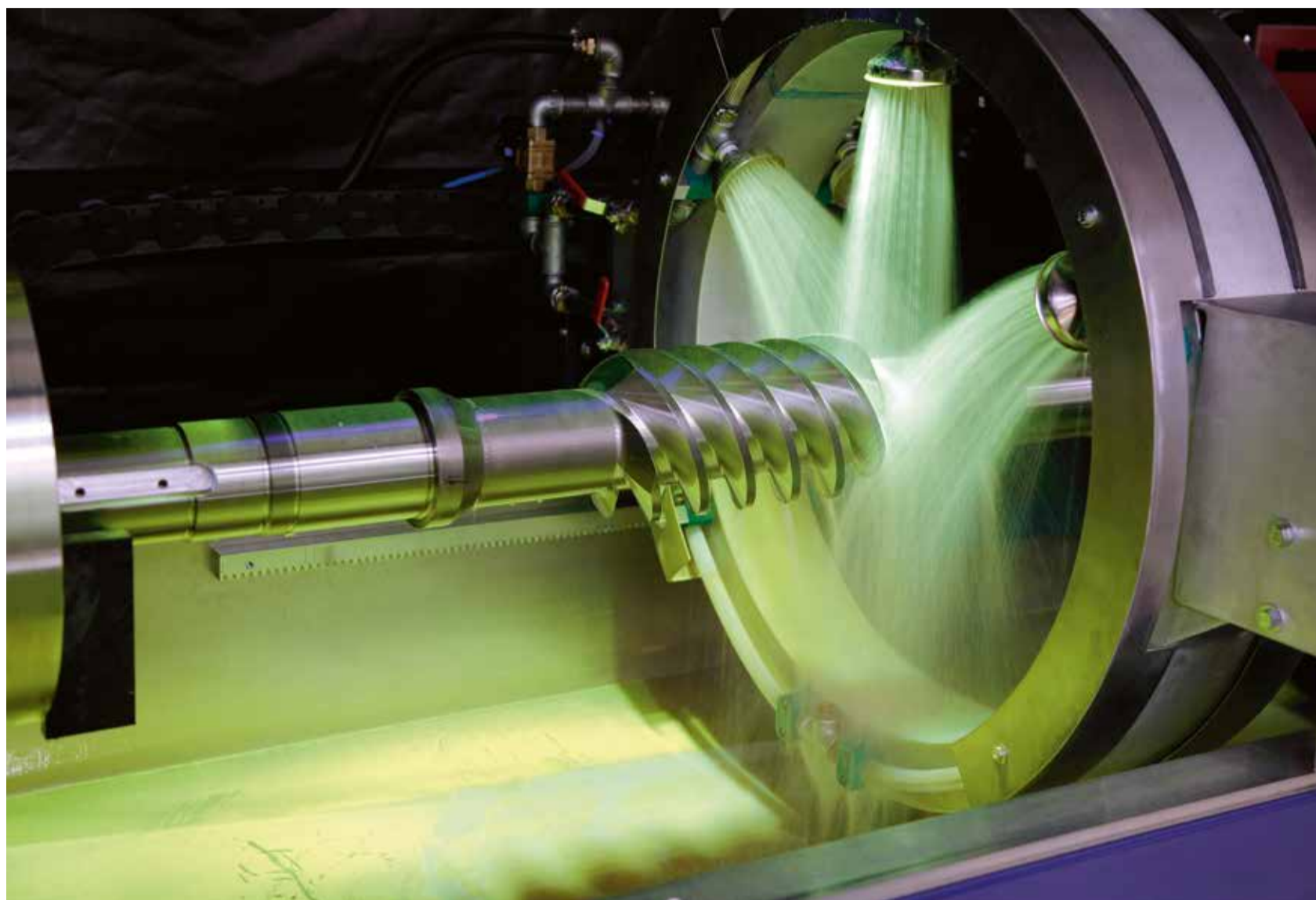
Qualität made in der Region Kassel: Die Henschel Antriebstechnik setzt auf höchste Präzision. Im Bild ein moderner Rissprüfstand.
