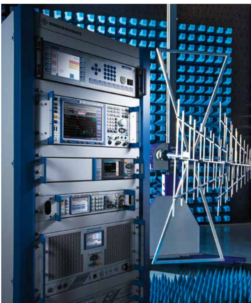
Die Testsystemplattform R&S CEM5100 ist eine flexible und zuverlässige Off-the-Shelf-Lösung für gestrahlte Störfestigkeitstests.
