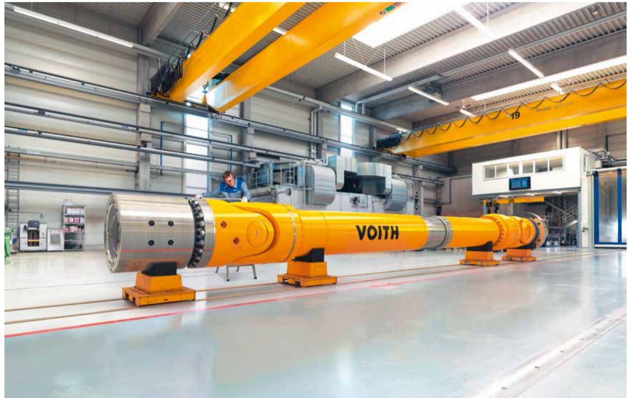
Voith-Gelenkwellen werden für Walzwerke, Baumaschinen, Schiffsantriebe und Schienenfahrzeuge verwendet. © Voith
