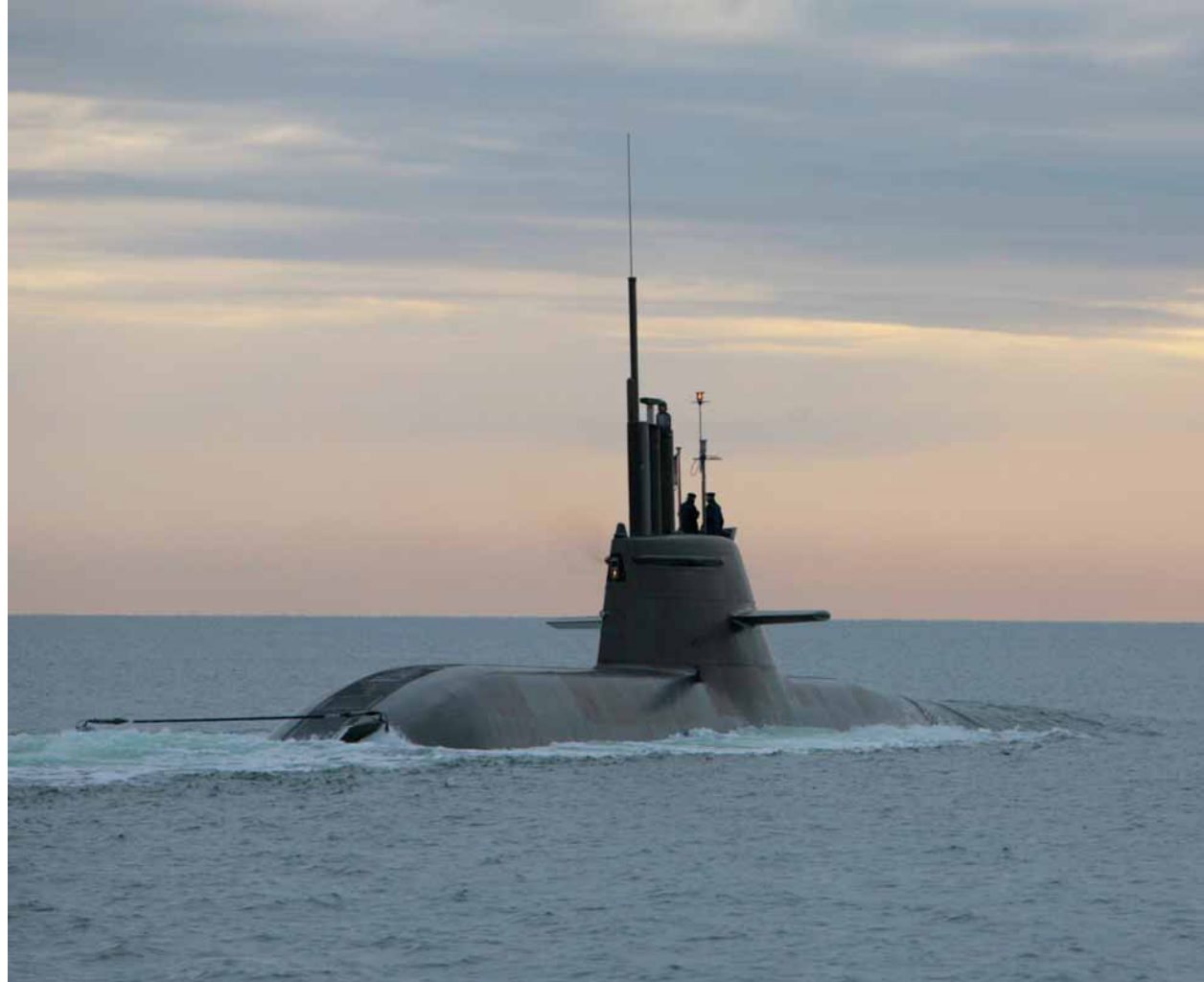
Exportschlager aus Kiel: Die U-Boote der U 212 A Klasse werden mit Brennstoffzellentechnologie betrieben.
