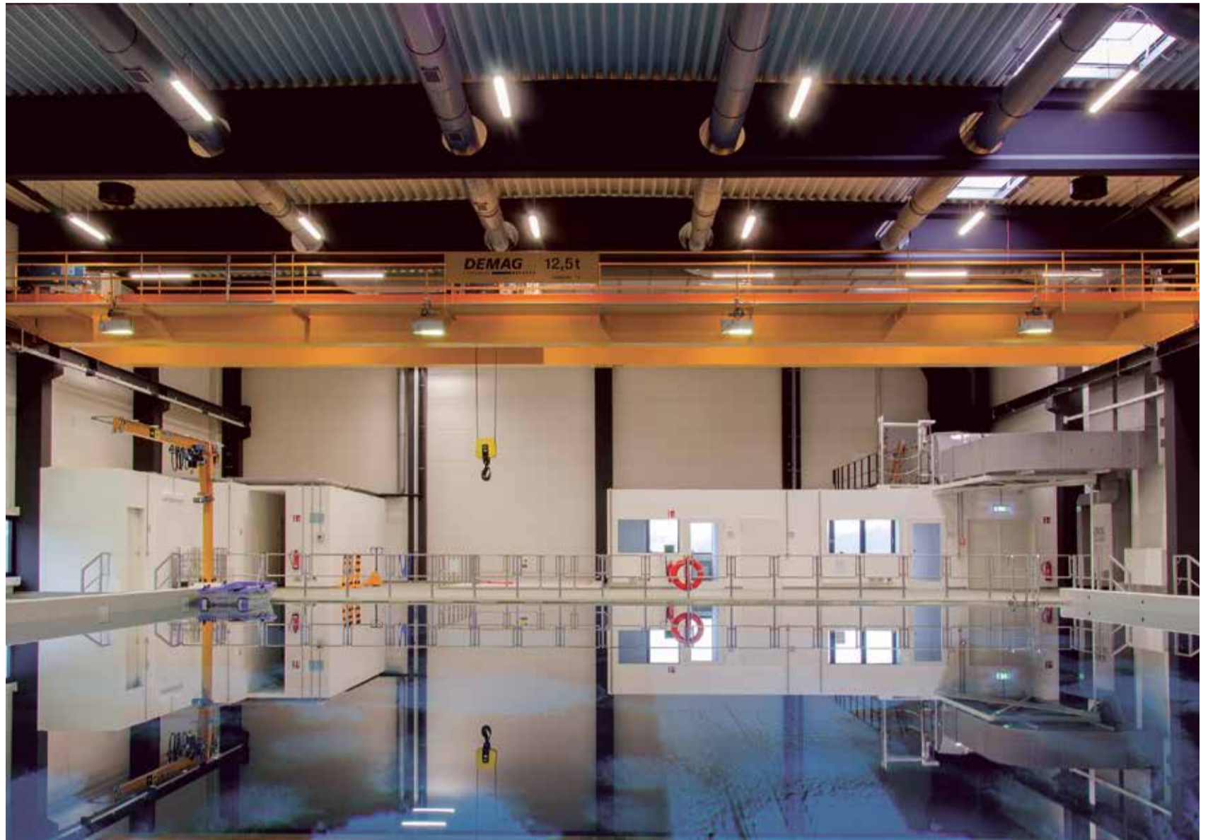
In Europa einzigartig: Die Testanlage für Unterwassersysteme des Deutschen Forschungszentrums für Künstliche Intelligenz (DFKI) in Bremen. Kernstück ist das 3,4 Millionen Liter umfassende Salzwasserbecken.
