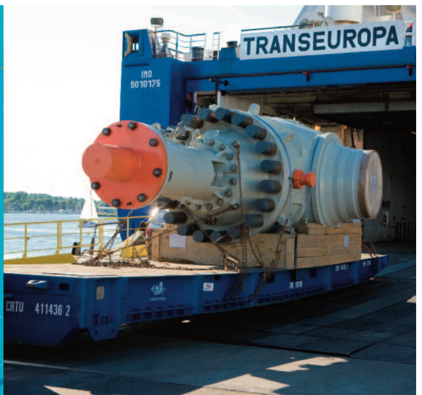
Bei der Nord Stream-Pipeline ist alles gigantisch: 860.000 Hightech-Großrohre allein für den ersten Strang, acht Gasturbinen und zehn über 100 Tonnen schwere Absperrarmaturen (rechts). © Nord Stream
