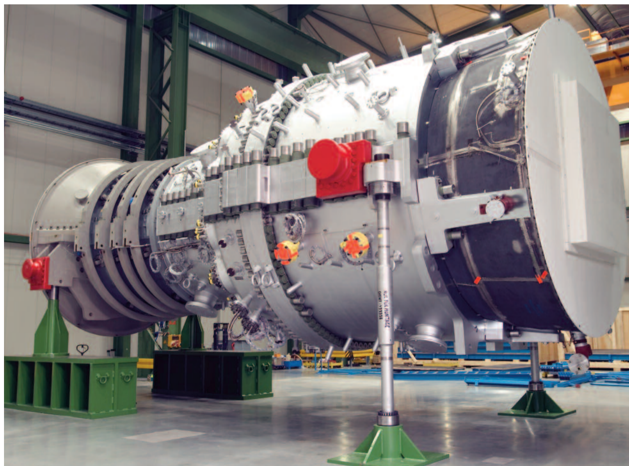
„Made in Berlin“ – die Siemens-Gasturbine mit dem höchsten Wirkungsgrad: Hightech pur mit 444 Tonnen.
