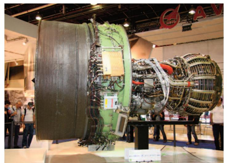
Größenvergleich: Mensch und Triebwerk GENx-2B67 für die 747-8 I.
