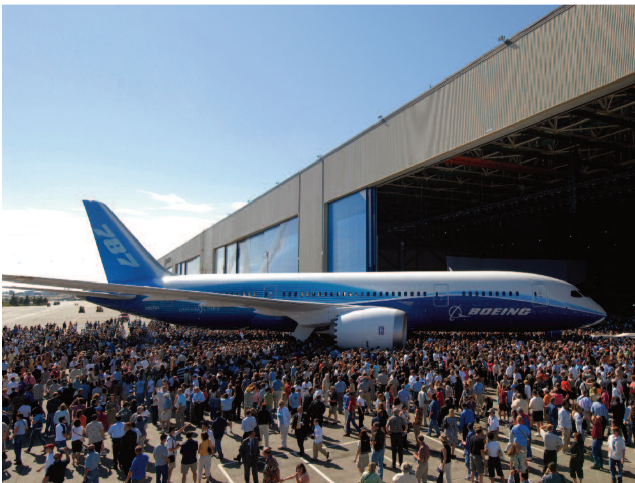
Die Boeing 787 Dreamliner besteht zu 50 Prozent aus Verbundwerkstoffen und spart somit Gewicht.
