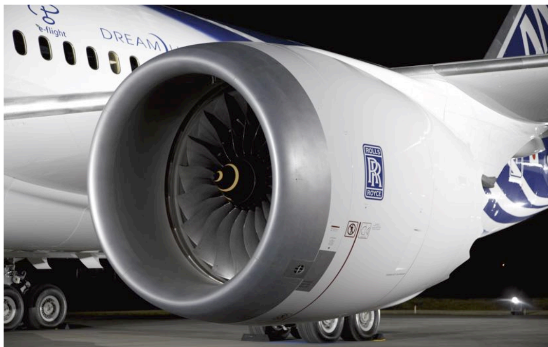
Das riesige Rolls-Royce Trent Triebwerk 1.000 für den Boeing 787 Dreamliner sorgt für den nötigen Schub. © Rolls-Royce
