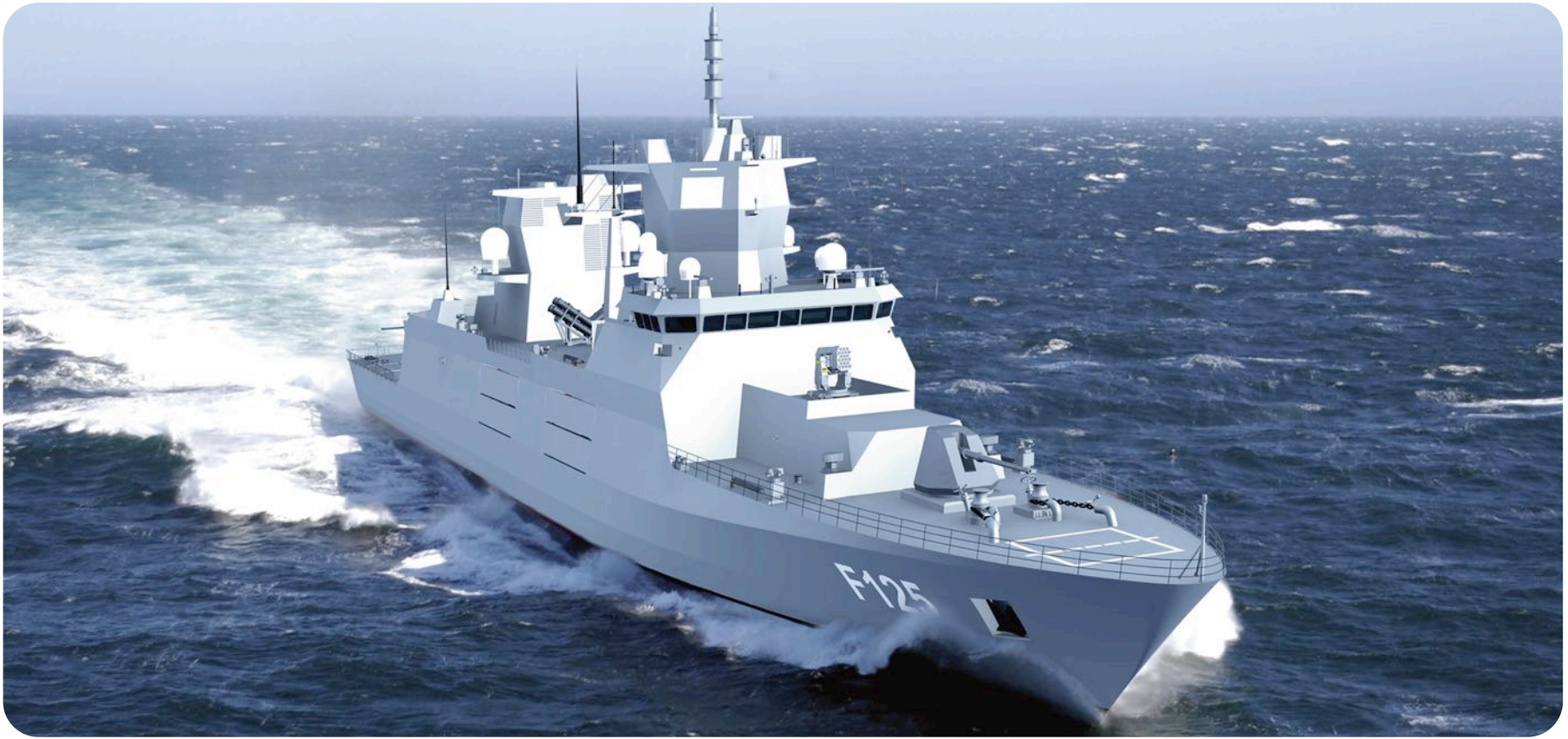
Die neue innovative Fregatte F 125 ist ein Beitrag der Sicherung der Seewege für die Handelsnation Deutschland. Angetrieben wird das Schiff von vier MTU Dieselmotoren.
