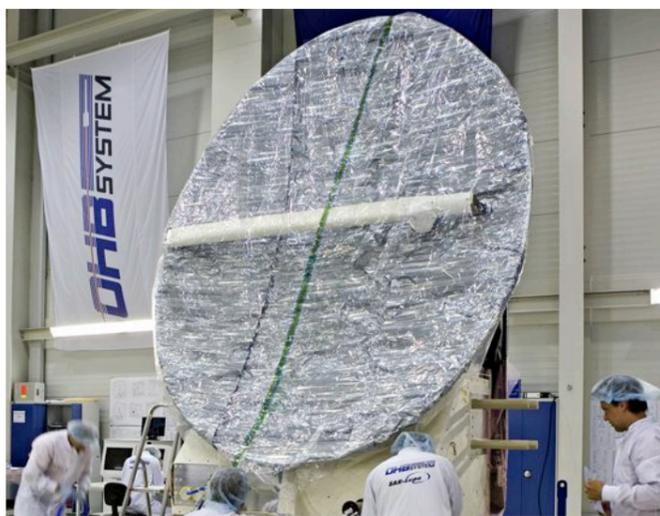
Integration eines SAR-Lupe-Satelliten bei OHB in Bremen. Der Bau des satellitengestützten Radarsystems SAR-Lupe bedeutete 2001 den Durchbruch für OHB in der Raumfahrttechnikbranche. © OHB AG
