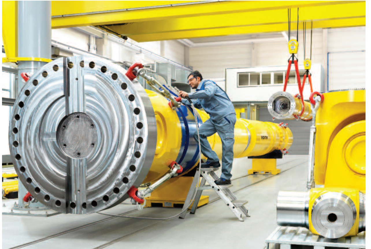
Voith-Gelenkwellen werden u. a. für Walzwerke, Baumaschinen, Schiffsantriebe und Schienenfahrzeuge verwendet. © Voith
