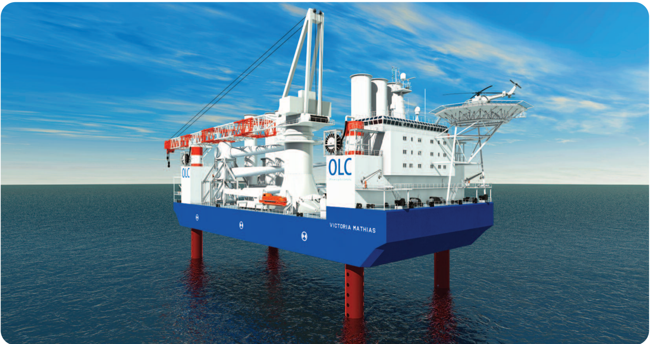
So wird der Einsatz der „Viktoria Matthias“ auf hoher See aussehen: Mit den 80 Meter hohen Beinen kann sich die Arbeitsplattform in bis zu 40 Meter tiefem Wasser fest verankern.
